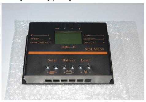
Se trata de un regulador de carga PWM, tiene un consumo muy bajo en espera de sólo 10 mA-15 mA.
